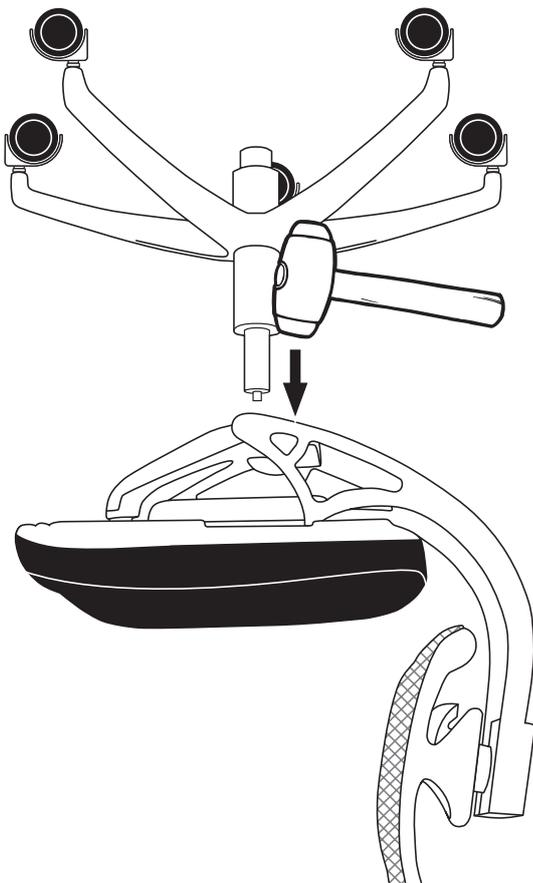
Lösen des Liftes aus dem Sitzträger. Wie auf Bild 1 gezeigt, wird mit einem Gummihammer bzw. herkömmlichen Hammer auf die Metallplatte unter dem Polstersitz geklopft, um die Steckverbindung des Stuhles zu lösen.
